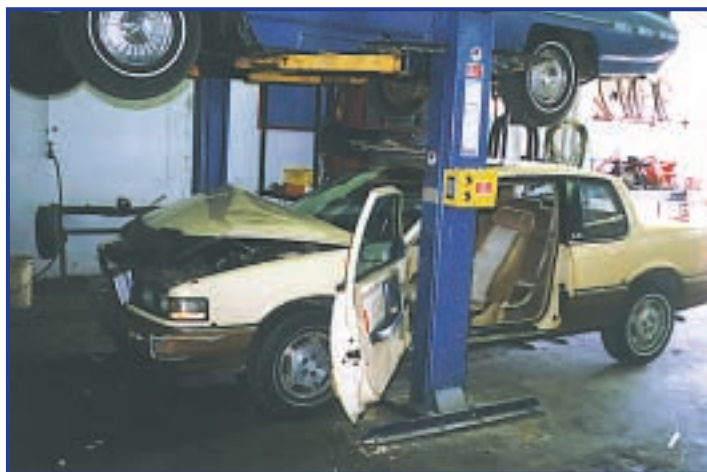
Ce qui se produit quand un élève ne respecte pas les directives. Le véhicule s'est déplacé vers l'avant, emprisonnant un élève entre la table de travail et le mur, et enfonçant une pièce métallique de la table dans la jambe de l'élève. Trois autres élèves ont subi des blessures quand le véhicule a été mis en marche arrière puis coincé contre le palan.
